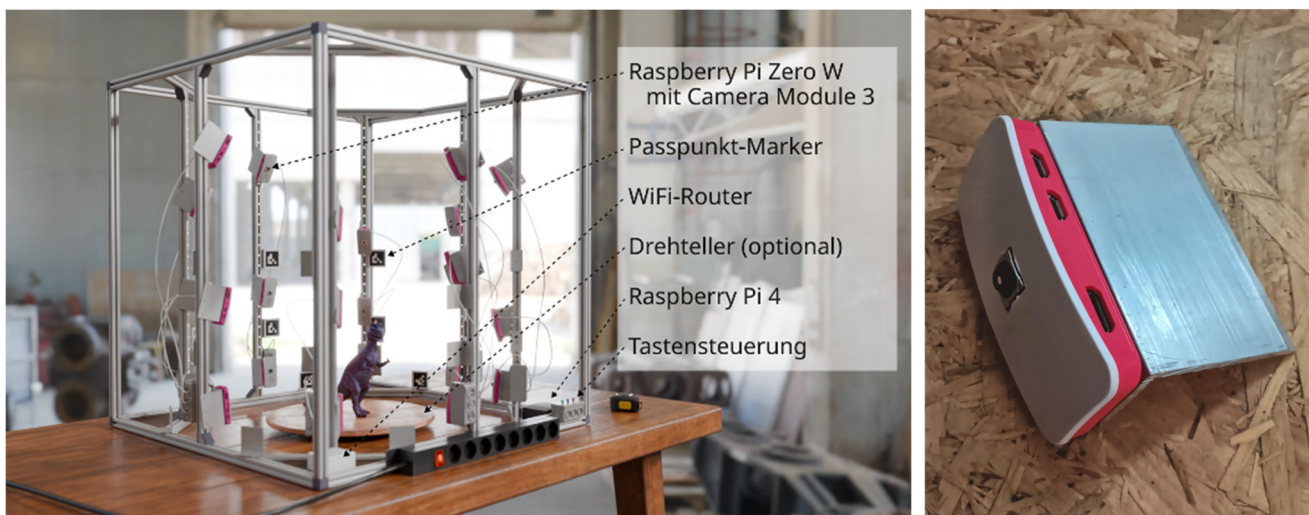
Abbildung 1 links: Komponenten des Messsystems (3D-Visualisierung); rechts: Raspberry Pi Zero W mit Kameramodul 3 und Haltewinkel (noch ohne Bohrung)
