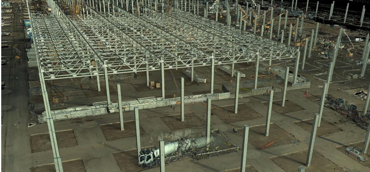
Abb. 3: Eingefärbte Punktwolke einer Baustelle, aufgenommen im laufenden Baustellenbetrieb
