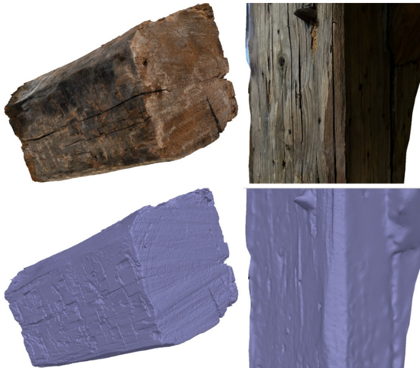
Abb. 2: Photogrammetrische texturierte (oben) und Oberflächenmodelle (unten); links: Nikon D3400 mit AF-S NIKKOR 50 mm 1:1,8 G-Objektiv; rechts: iPhone 14 Pro (3D Scanner App)
