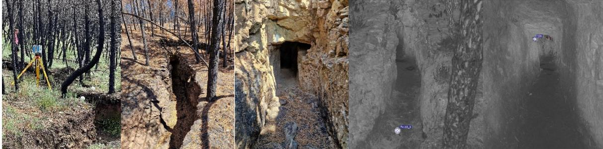
Abb. 13: Terrestrisches Laserscanning in Pedroso mit dem Z+F IMAGER 5010 im Gelände (links), Tunnelleingänge (Mitte) und deren Punktwolken (rechts)
