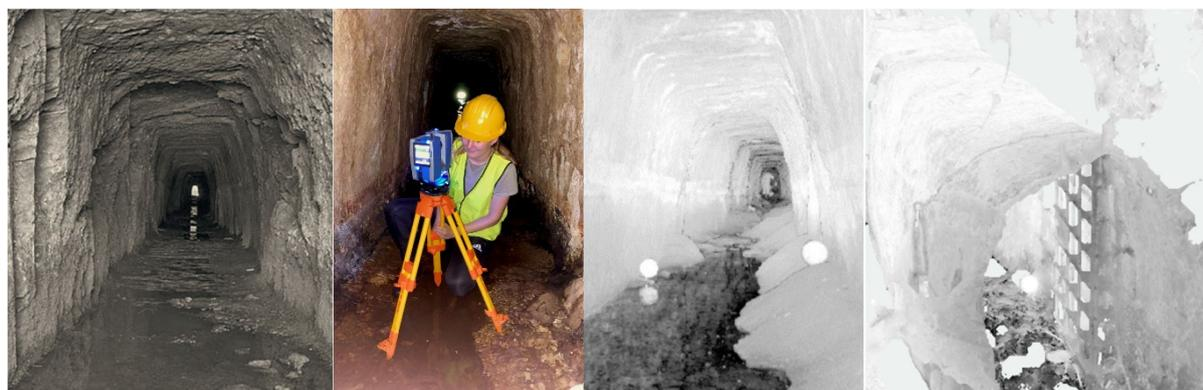
Abb. 7: Der Entwässerungstunnel Buraco Seco (links), der Laserscanner Faro Focus<sup>3D</sup> X330 im Tunnel (Mitte) und zwei Scans (rechts)
