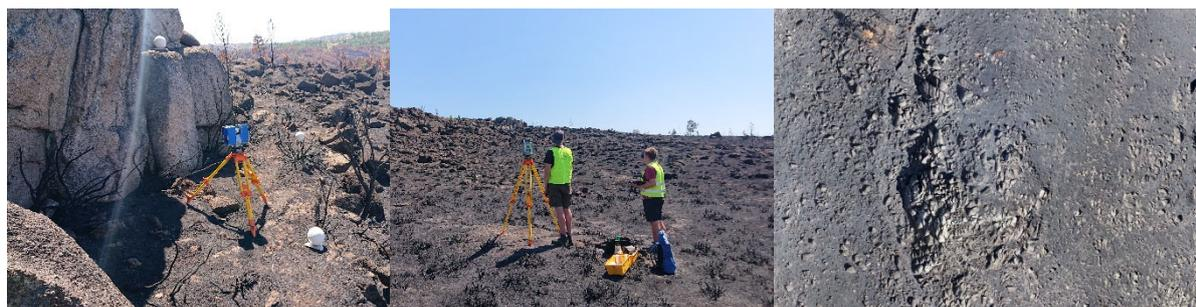
Abb. 15: Terrestrisches Laserscanning im Steinbruch Fonte da Ribeira (links), Passpunktbestimmung mit Tachymeter (Mitte) und Ausschnitt eines UAV-Orthophotos (rechts)
