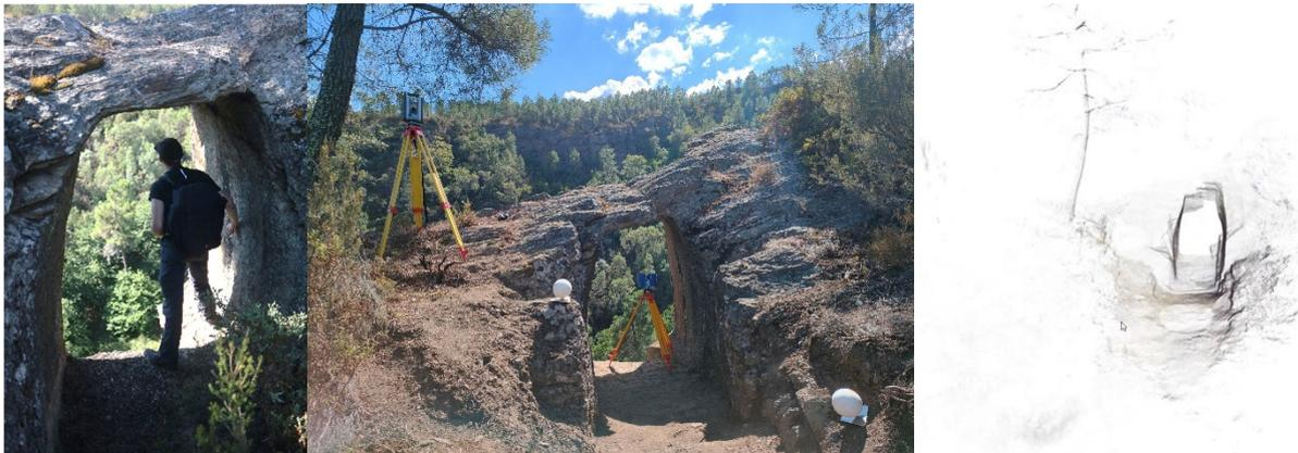
Abb. 9: Galeriefragment in Ribeirinha (links), Laserscanning der Galerie (Mitte) und Punktwolke der Galerie (rechts)
