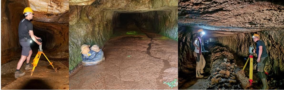
Abb. 8: Die Galerie dos Morcegos (Mitte), Kugelpanoramaaufnahme mit Nodalpunktadapter (links) und Polygonzugmessung mit Tachymeter (rechts)
