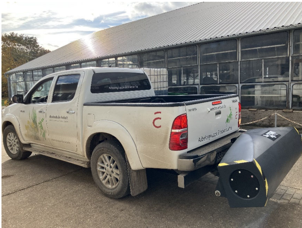
Abb. 4 Messfahrzeug Toyota Hilux mit auf Anhängerkupplung montiertem Topsoil Mapper
