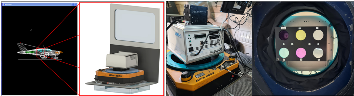
Abb. 4: Links: 3D-CAD-Zeichnungen. Mitte: AMC-6 System in GSM4000. Rechts: Blick durch die Bodenluke auf die austauschbare Filterplatte. Konzipierung des Einbaus und Sensortechnik in Trägerplattform Cessna T303 Crusader verbaut. Flugplatz Kamenz (EDCM).
