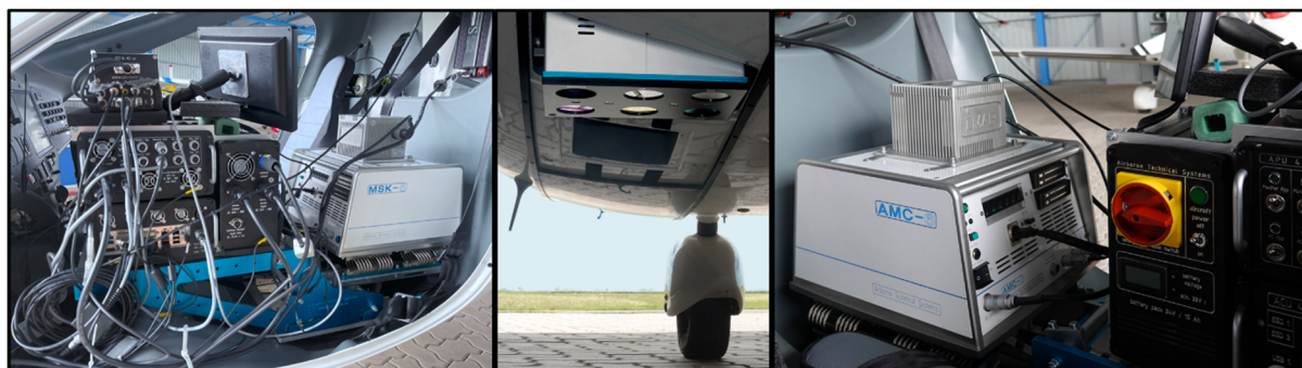
Abb. 3: Links: Eingebautes Messsystem mit „AMC-6“, Messsensorik zur Positions- und Lagebestimmung, Bildschirm, Rechen- und Stromversorgungseinheit. Mitte: Blick durch die Bodenluke. Rechts: Multispektralkamera im Gyrocopter „D-MHSA“. Flugplatz Magdeburg (EDBM)
