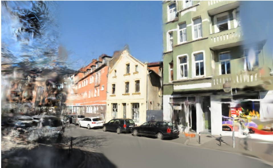
Abb. 6: Synthetisierte Sicht aus der Perspektive von Bild 13 mit Prior aus LiDAR Punktwolken
