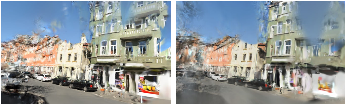
Abb. 7: Vergleich der Sichtqualität aus neuer Perspektive mit Prior LiDAR (links) und mit Prior zufallsverteilte Punktwolke (rechts)
