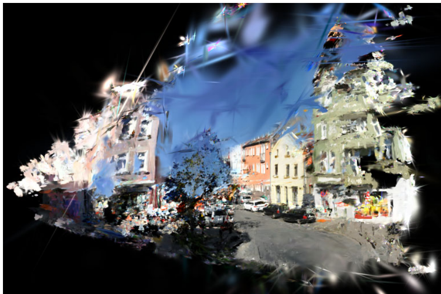
Abb. 5: Überblick über die gesamte Gaussian Splatting Szene mit SfM Prior. Rekonstruiert wurden nur die Fassaden in Nordrichtung (rechts im Bild), sowie die Stirnseite des Hauses im Westen (links im Bild)
