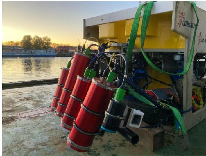
Abb. 1: UWSensor montiert im hydraulischen Manipulator eines Tauchroboters von Baltic Taucherei- und Bergungsbetrieb Rostock.
