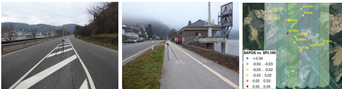
Abb. 8: Höhenkontrollpunkte und Abweichung der Modellergebnisse zu den Kontrollpunkten
