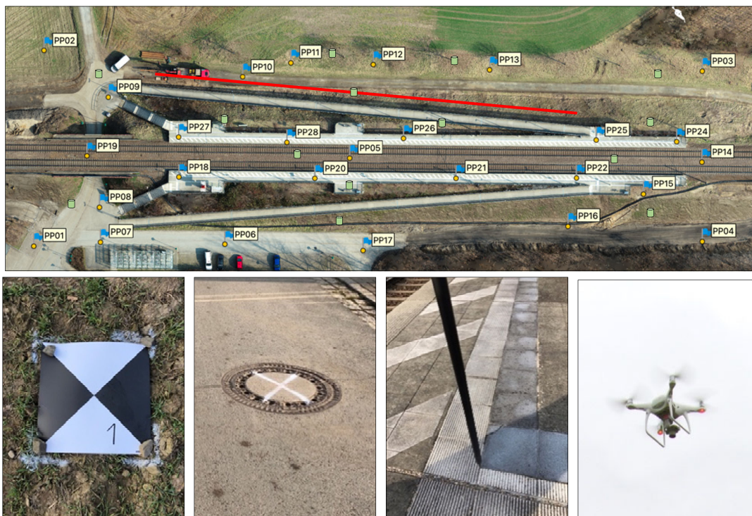
Abb. 1: Oben: Übersicht der Passpunktverteilung (gelb), Höhenprofil (rot) und TLS-Positionen (grün). Unten v.l.n.r.: Passpunktmarkierungen (schwarz-weiß Targets, aufgesprühte Farbmarkierungen, markante Punkte in der Örtlichkeit), DJI Phantom 4 RTK.
