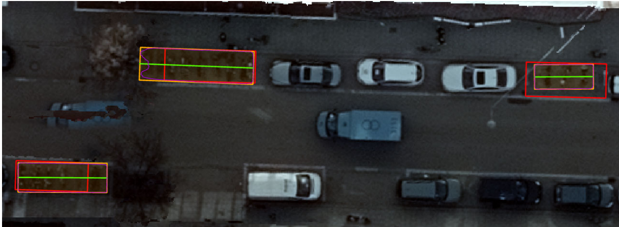
Abb. 2: Ausschnitt aus RGB-Orthophoto (Weißenburger Straße) mit gelabelten Fahrradständern in Rot, detektierten Fahrradständern in Lila, daraus berechneten Rechtecken in Orange und Linien in Grün (Bildquelle: LANDESHAUPTSTADT MÜNCHEN – KOMMUNALREFERAT – GEODATENSERVICE 2020)
