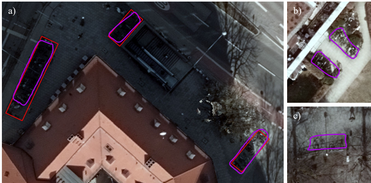
Abb. 4: Beispiele richtig positiver Detektionen: a) korrekt markierte Fahrradständer-Objekte in Lila mit gelabelten Fahrradständern in Rot (Rosenheimer Platz); b) private Fahrradstellplätze (Spicherenstraße); c) einzelne Fahrräder angelehnt an ein Geländer (Weißenburger Platz) (Bildquelle: LANDESHAUPTSTADT MÜNCHEN – KOMMUNALREFERAT – GEODATENSERVICE 2020)
