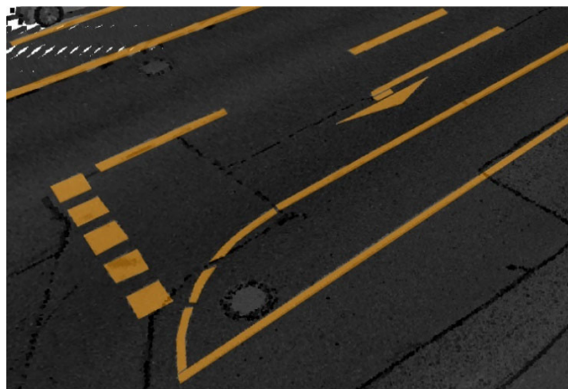
Abb. 3: 3D-Punkt wolke, in der identifizierte Straßenmarkierungen als orangefarbene Shapes eingeblendet sind
