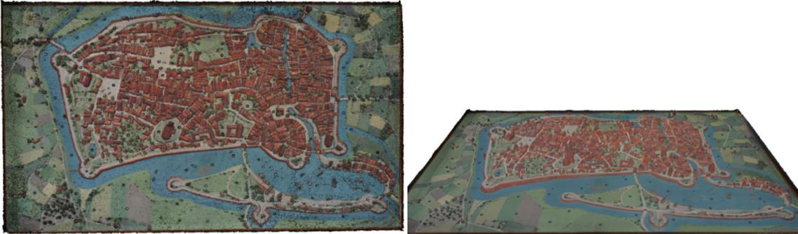
Abb. 3: Dichte 3D-Punktwolke des physikalischen Stadtmodells von Stade im Jahr 1620 (links) und perspektivische Ansicht des texturierten, vermaschten 3D-Modells (rechts)
