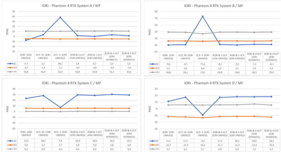
Abb. 12: Änderungen der Parameter der Inneren Orientierung ( \Delta c , XH, YH) in Abhängigkeit von der Blocklagerung sowie gemeinsamer bzw. separater Parameter für die Teilflüge (Systeme A – D). Hinweis: die Abweichungen \Delta c beziehen sich auf einen einheitlichen Startwert
