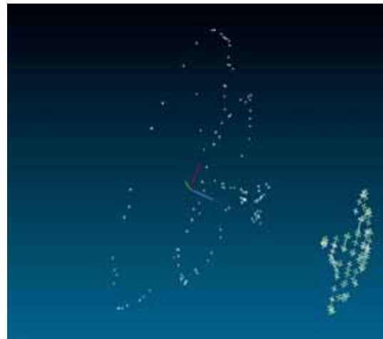
Abb. 6: Geplante (links) und tatsächlich geflogene Aufnahmeconfiguration für eine Elevationsposition
