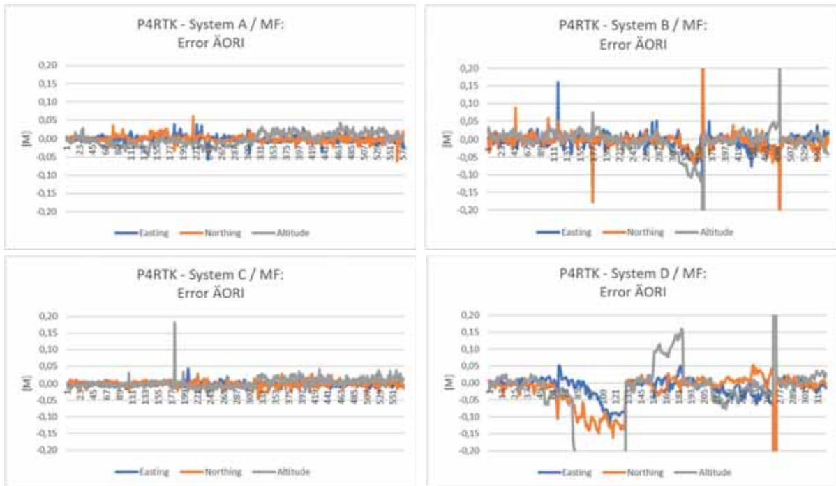
Abb. 5: Verbesserungen (Error) an den durch RTK bestimmten Bildpositionen (ÄORI) nach der BBA für die Systeme A – D
