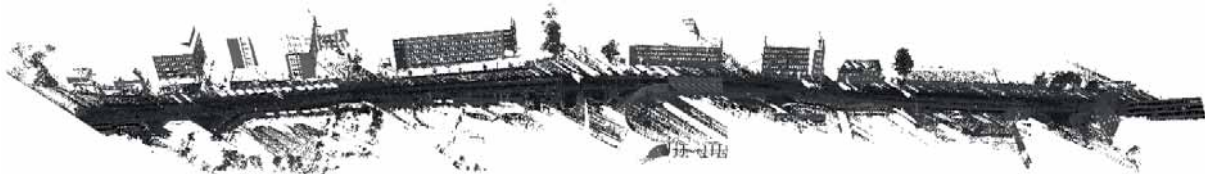
Abb. 2: 3D-Punktwolke einer Straße, die als Eingabe für die Erkennung von Straßenmarkierungen genutzt wurde
