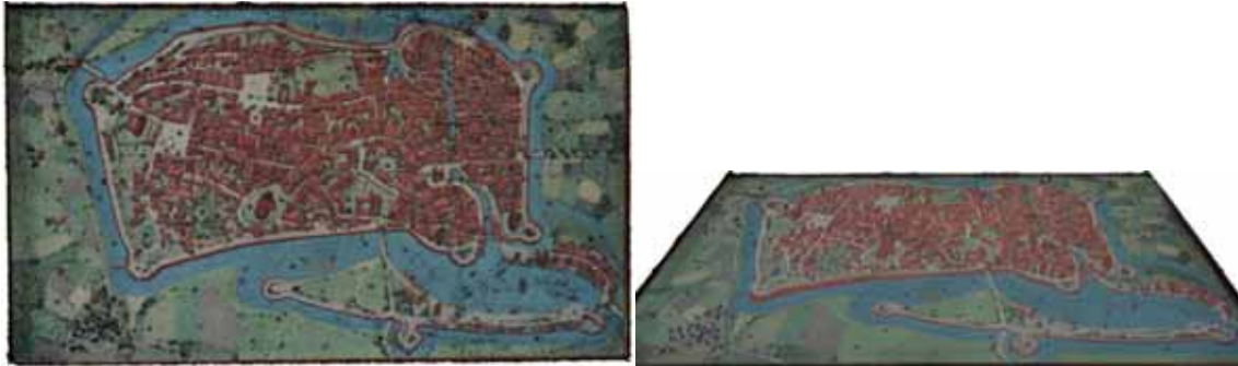
Abb. 3: Dichte 3D-Punktwolke des physikalischen Stadtmodells von Stade im Jahr 1620 (links) und perspektivische Ansicht des texturierten, vermaschten 3D-Modells (rechts)
