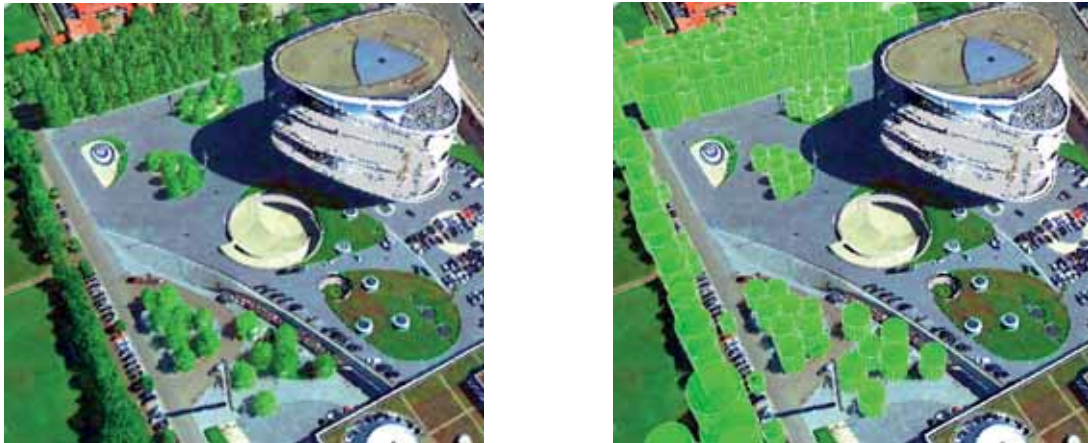
Abb. 5: Darstellung der integrierten Ergebnisse des gesamten M3D-Datensatzes ( links : kolorierte Punktwolke als Eingabedaten, rechts : durch Datenintegration rekonstruierte gemittelte Zylinder)
