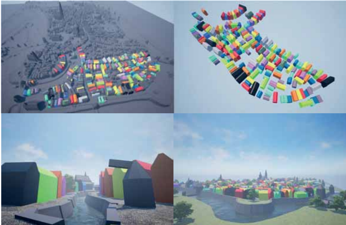
Abb. 4: Ansichten vom ersten Bearbeitungsschritt in der Unreal Engine: Platzierung von einfachen Gebäudeklötzchen auf die Höhenkarte, die aus der Dreiecksvermaschung der Punktwolke generiert wurde (links oben). Die verschiedenfarbigen Klötzchen stellen jeweils unterschiedliche Varianten des Stadthauses dar
