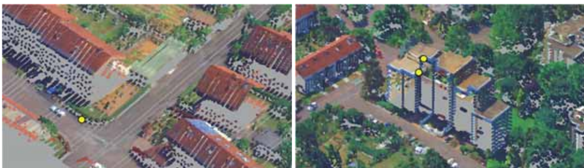
Abb. 5: Fehlklassifikationen durch die Crowdworker (gelb). Diese sind teils auf Verdeckungen ( links ) zurückzuführen, teilweise sind diese aber auch definitionsabhängig ( rechts )
