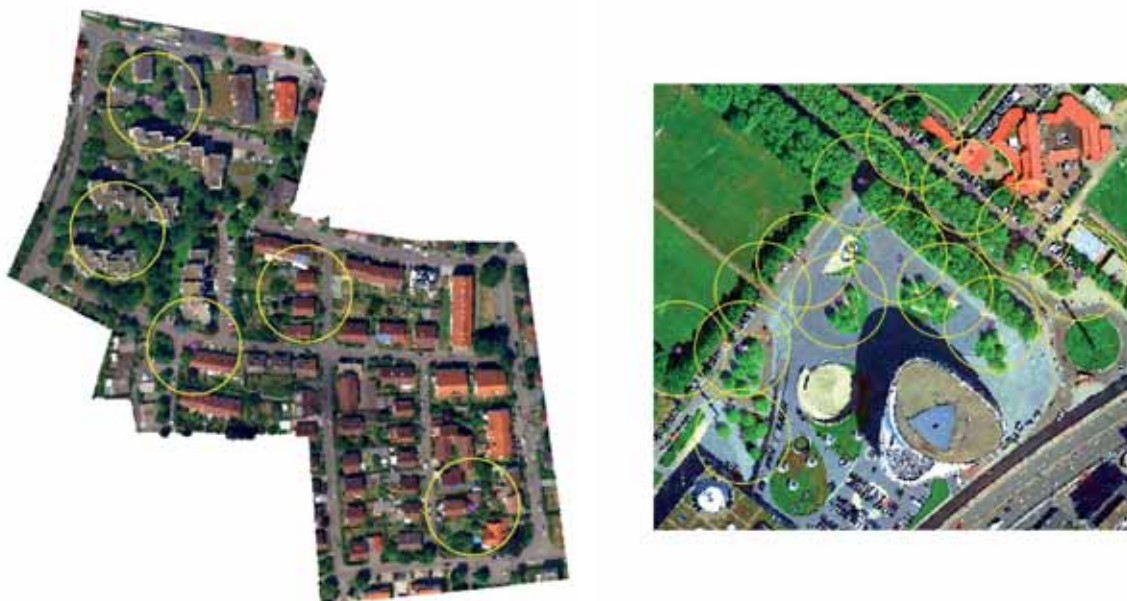
Abb. 2: Kolorierte ALS Punktwolke und davon ausgewählte kreisförmige Erfassungsbereiche mit einem Radius von 30 m ( links : V3D-Datensatz, rechts : M3D-Datensatz)
