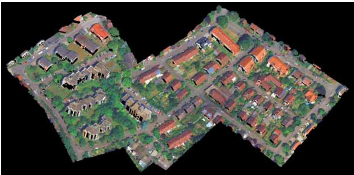
Abb. 3: Mittels Orthophoto kolorierter V3D-Trainingsdatensatz
