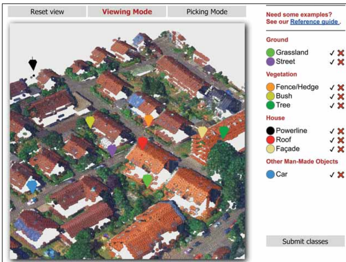
Abb. 2: Implementiertes Webtool zur Angabe repräsentativer Vertreter der einzelnen Klassen in der voll-interaktionsfähigen Punktwolke
