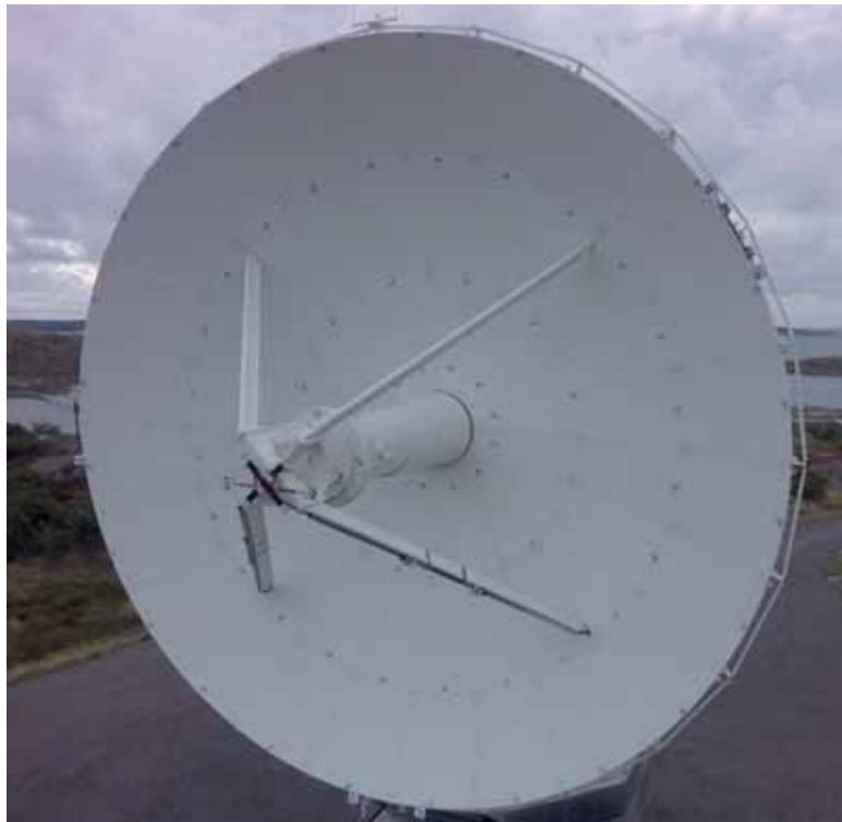
Abb. 5: Zielmarken am Hauptreflektor, Kreuz mit Passpunkten zur Lagerung sowie Maßstäbe vorne am Subreflektor, an den Streben und am Rand des Hauptreflektors
