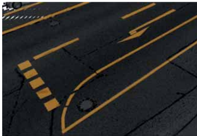
Abb. 3: 3D-Punktwolke, in der identifizierte Straßenmarkierungen als orangefarbene Shapes eingeblendet sind
