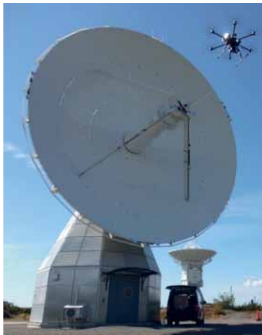
Abb. 1: Nordöstliches Onsala Twin Teleskop (ONSA13NE) mit Hexacopter (Hexapilots HP-TS960) während der Befliegung in der 0^\circ Elevationsposition. Im Hintergrund erkennbar: Südliches Teleskop in 90^\circ -Stellung (Opferschalenstellung)
