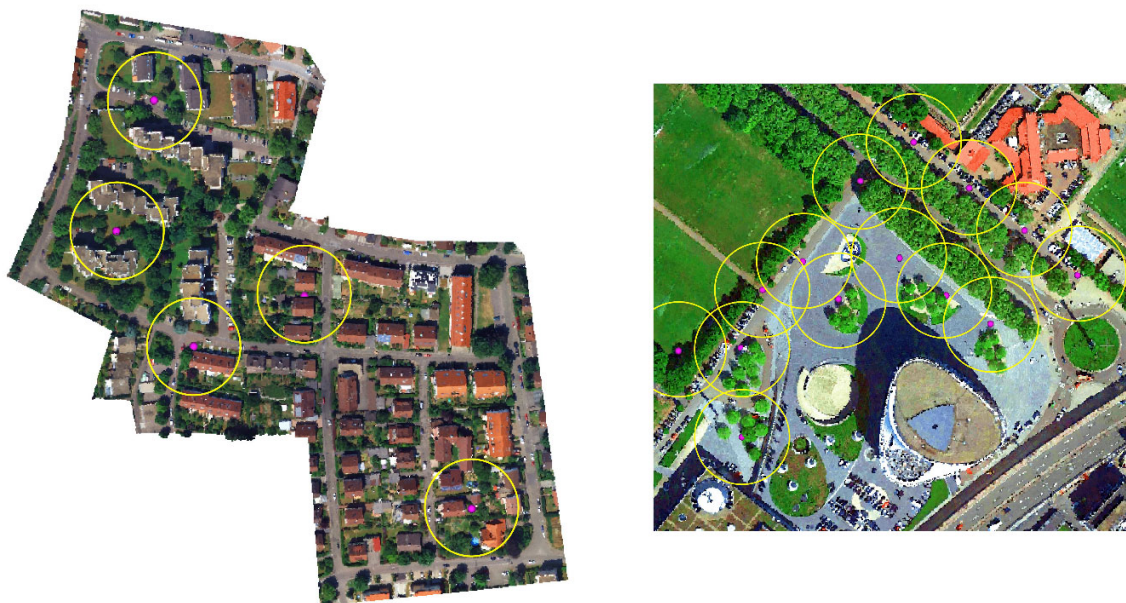
Abb. 2: Kolorierte ALS Punktwolke und davon ausgewählte kreisförmige Erfassungsbereiche mit einem Radius von 30 m ( links : V3D-Datensatz, rechts : M3D-Datensatz)
