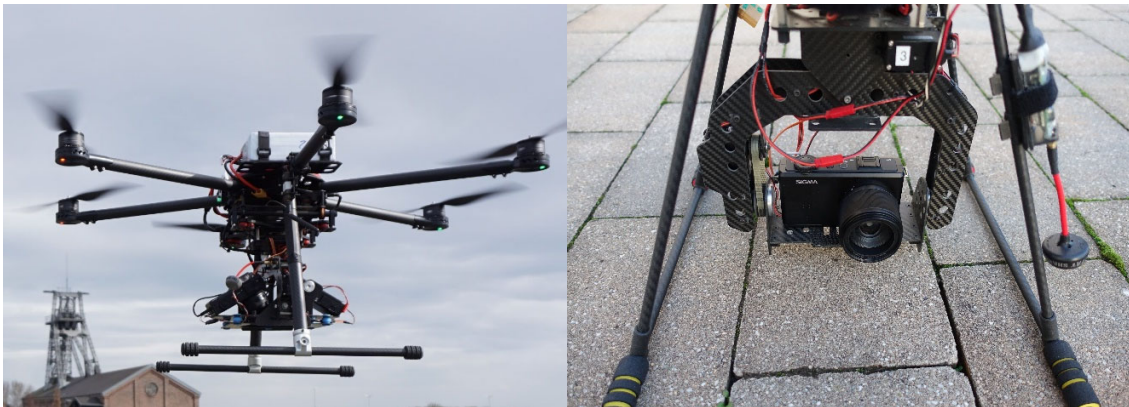
Abb. 3: Hexapilots HP-TS960 (links) und für die Aufnahmen eingesetzter Kameragimbal (rechts) zur Orientierung der Kamera auf das Messobjekt
