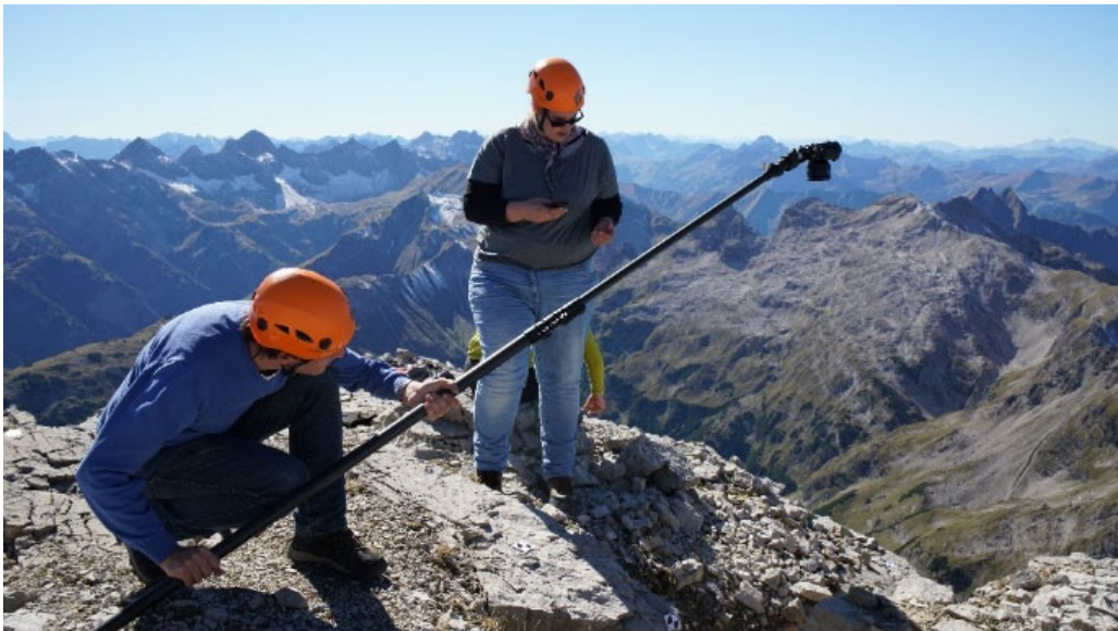
Abb. 2: Photogrammetrische Vermessung der Spalten im Gipfelbereich des Hochvogels mit Stangenstativ, Kamera und WiFi-Steuerung
