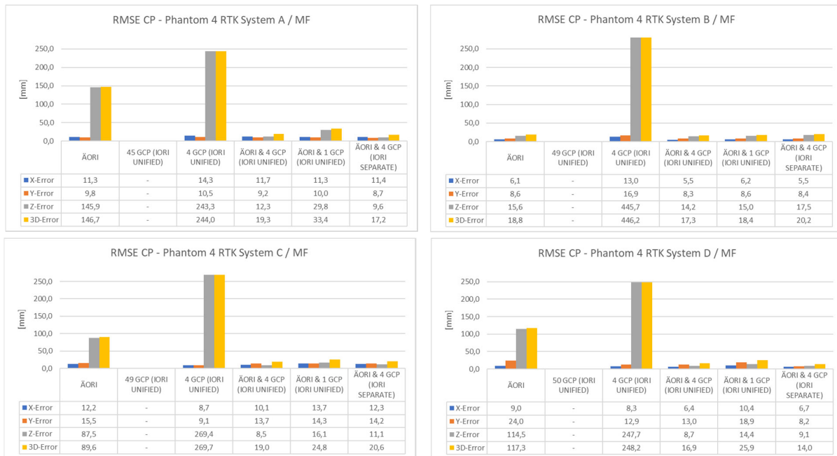
Abb. 7: RMSE-Werte an den Kontrollpunkten (CP) in Abhängigkeit von der Lagerungsart (direkt: ÄORI – indirekt: GCP – integriert: ÄORI+GCP) (Systeme A – D). Hinweis: die vertikale Skalierung weicht von der der GCP (Abb. 6) um den Faktor 10 ab
