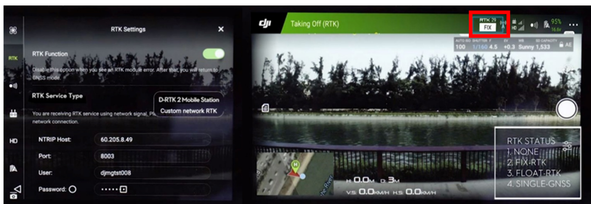
Abb. 2: Definition der RTK-Einstellungen in der GS PRO Applikation (Fotos: Hersteller)
