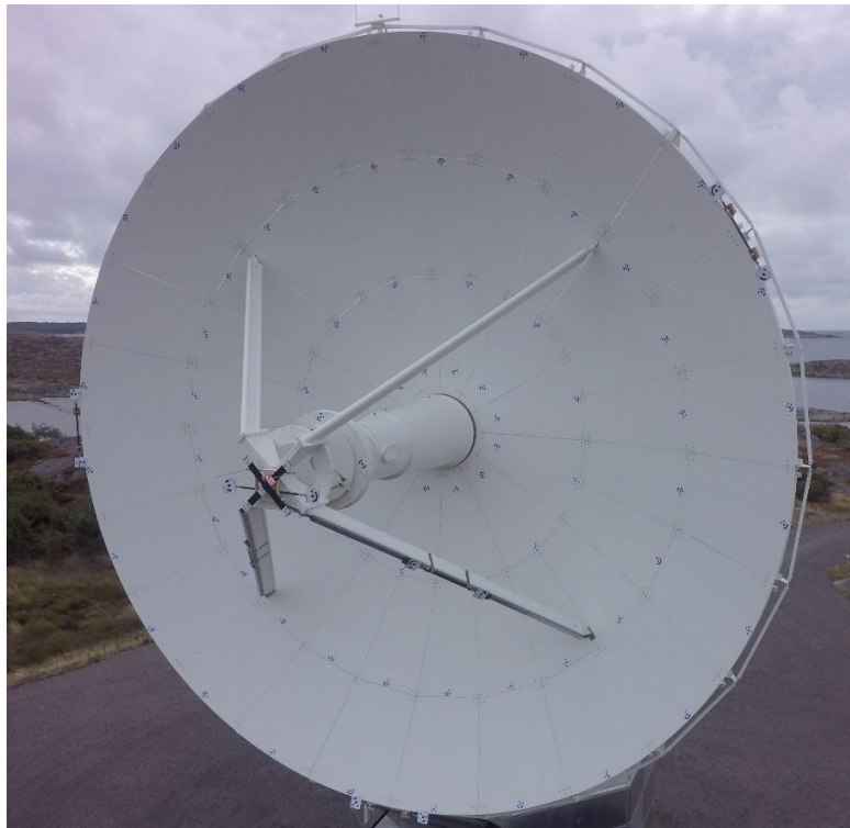
Abb. 5: Zielmarken am Hauptreflektor, Kreuz mit Passpunkten zur Lagerung sowie Maßstäbe vorne am Subreflektor, an den Streben und am Rand des Hauptreflektors
