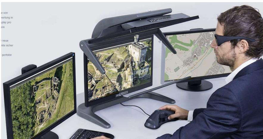
Der neue 3D PluraView basiert auf der Beamsplitter-Technologie und ermöglicht so hochauflösende 3D-Stereo-Visualisierungen mit einem flimmerfreien, tageslichttauglichen 3D-Display, das ein nahezu ermüdungsfreies stereoskopisches Arbeiten über Stunden garantiert.
