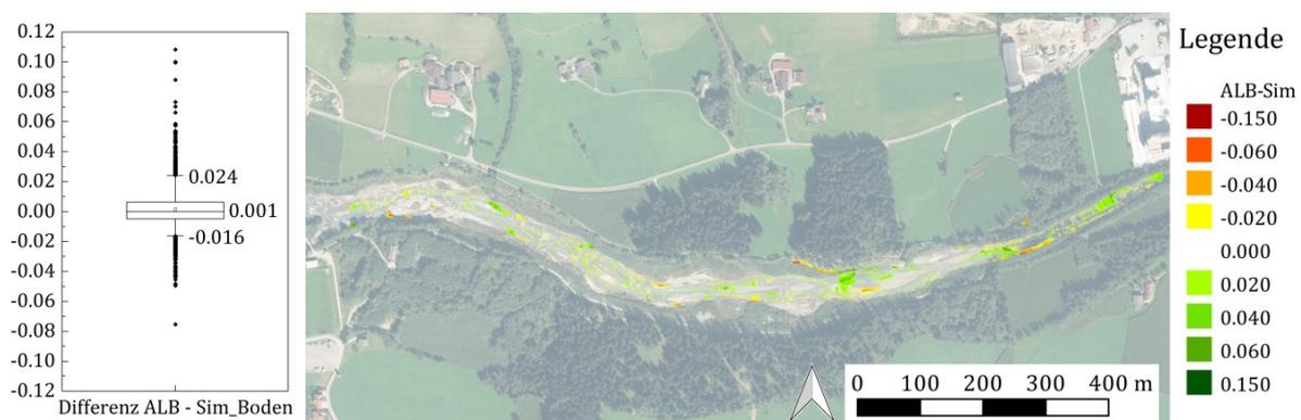
Abb. 5: Ergebnis der Refraktionskorrektur; links: Boxplot der Differenz zwischen den Bathymetrien nach Methoden Eins und Zwei; rechts: Differenzenplot, flächige Darstellung lokaler Abweichungen
