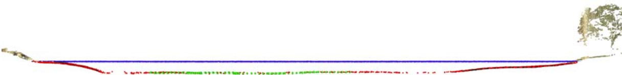
Abb. 10: Elbe-Querschnitt mit ALB-Online-Punkten (Gelände & Vegetation) eingefärbt nach RGB sowie Wasserspiegel in blau und Echolot 2015 in grün. In rot sind die Offline-klassifizierte Sohlpunkte zum Vergleich aus der FWF eingeblendet.
