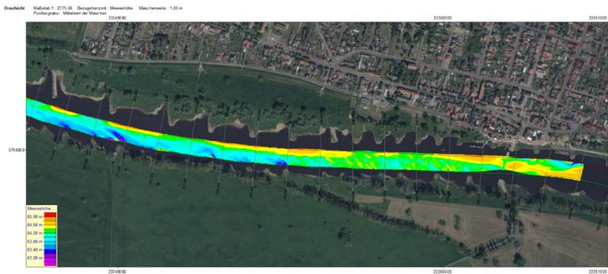
Abb. 1: Abschnitt der Elbe bei Elster (Elbe). Die aus Echolotmessungen des Vermessungsschiffes ROSSLAU extrahierten Gewässersohlenpunkte der Fahrrinne sind farbcodiert dargestellt. (Quelle: Bundesanstalt für Gewässerkunde)
