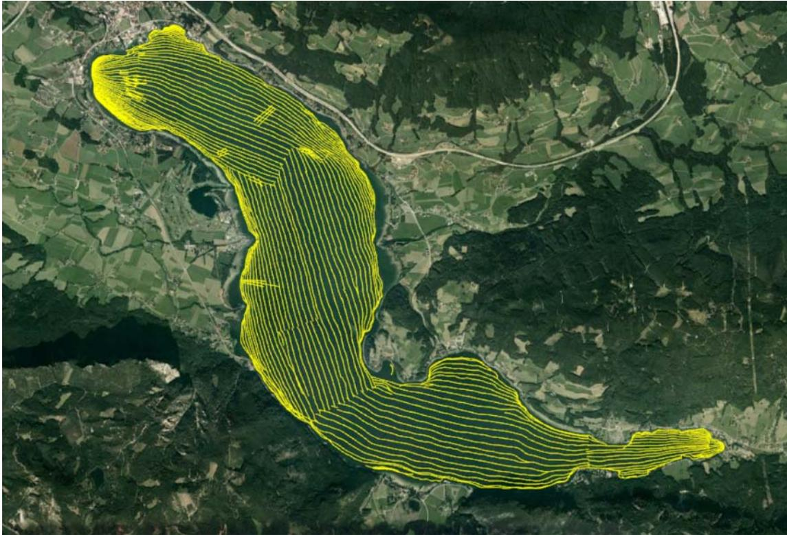
Abb. 2: Lage und Verteilung der Messprofile der Fächerecholotmessungen auf dem Mondsee mit einer Gesamtlänge von 304km
