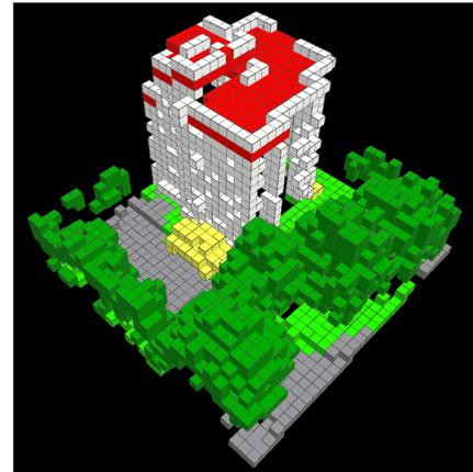
Abb. 3: Voxelisiertes Trainings-sample mit Kantenlänge  $32 \times 32 \times 64$  m und Voxelgröße 1 m. Die Klassen sind farbcodiert gemäß in Abb. 5.
