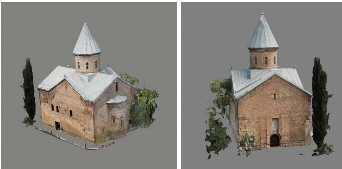
Abb. 10: Texturiertes und vermaschtes 3D-Modell aus PhotoScan (Alignment „medium“, Dense cloud „high“, Mesh „arbitrary, high“, Texture „adaptive orthophoto, mosaic“)
