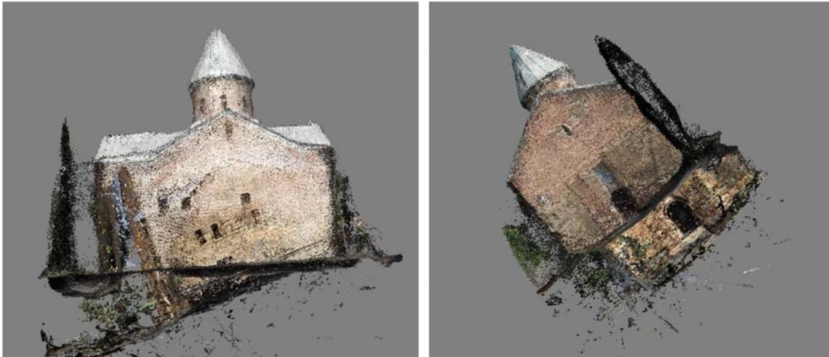
Abb. 8: Ansichten einer reduzierten dichten Punktwolke nach fehlerhafter automatischer Orientierung in PhotoScan 1.4.1; links: fehlerhafte Orientierung mit doppelter Rekonstruktion und Rotation; rechts: Frontansicht der Kirche mit doppelter Rekonstruktion des Eingangsportals
