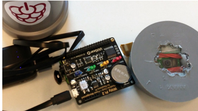
Abb. 2: Low-cost Raspberry Pi Kamera verbaut in einem wasserdichten PVC-Behälter. Ansteuerung erfolgt mittels eines Raspberry Pi Zero (hier installiert unterhalb des Witty Pi zur Speicherung der Uhrzeit)
