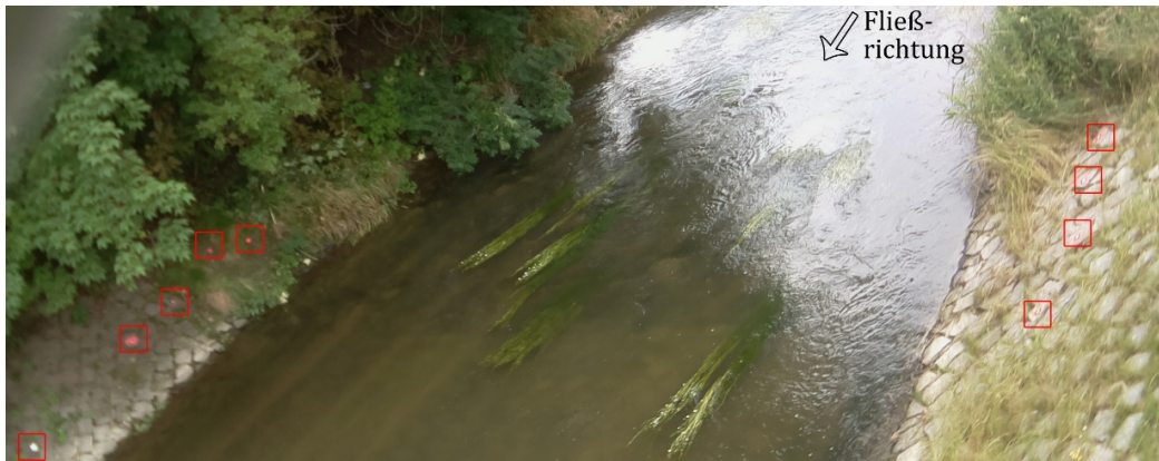
Abb. 3: Position der Passpunkte (innerhalb der roten Rahmen). Während des Beobachtungszeitraumes mussten weitere natürliche Passpunkte aufgrund von Verdeckungen durch Bewuchs zur Kameraorientierung hinzugezogen werden. Bild mit Raspberry Pi Kamera aufgenommen
