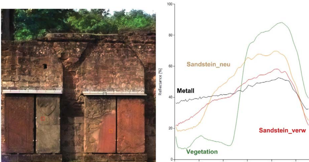
Abb. 3: Hyperspektrale Aufnahme in RGB-Darstellung mit punktuellen Abfragen (links) der Spektren ausgewählter Oberflächen (rechts)
