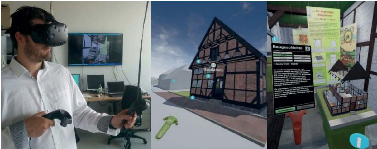
Abb. 7: Virtual Reality als intensives Erlebnis – Der Bildschirm im Hintergrund zeigt einen Ausschnitt dessen, was der Benutzer in der VR Brille sieht (links). Menüführung mit grünem Motion Controller durch „Laserstrahl“ (Mitte) und Menüinformationen an rotem Handcontroller (rechts).
