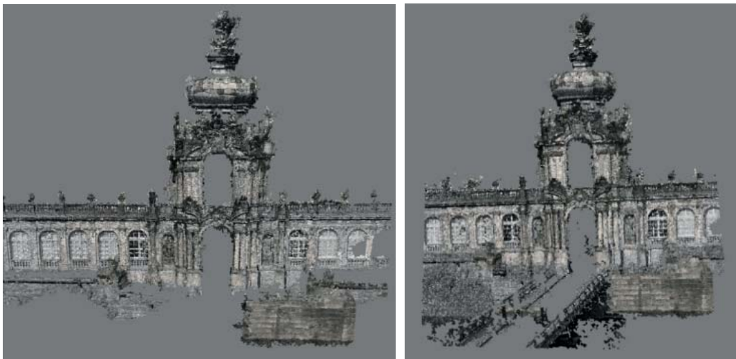
Abb. 8: Vergleich der Punktwolken basierend auf 11 (links) bzw. 13 (rechts) historischen Bildern
