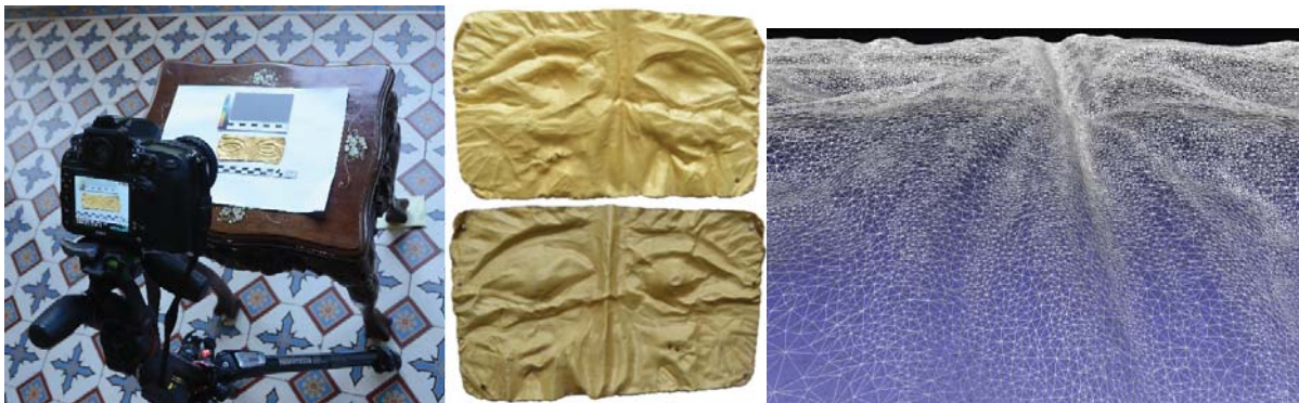
Abb. 4: Aufnahme-Setup für eine Goldmaske (links), 3D-Modell der Goldmaske in Vorder- und Rückansicht (Mitte) und detaillierter Ausschnitt der Dreiecksvermaschung (rechts)
