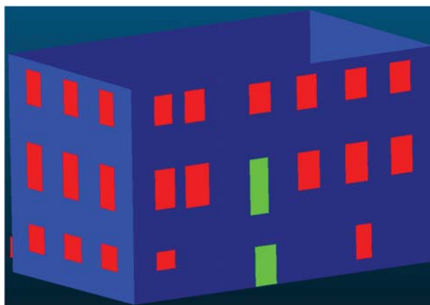
Abb. 4: 3D-Projektion der Ergebnisse der Interpretation von entzerrten Fassadenbildern mittels eines Convolutional Networks mit Fenstern (rot) und Türen (blau) für das Gebäude aus Abb. 1. Die Fassadenebenen wurden mit Hilfe des Ansatzes von NGUATEM & MAYER (2016) bestimmt.
