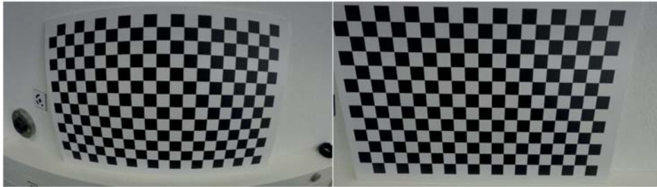
Abb. 6: Verzeichnetes (links) und verzeichnungsfreies Bild (rechts)
