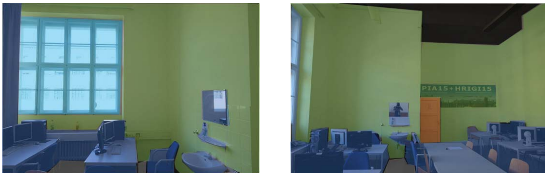
Abb. 2: Beispielergebnisse der 2D semantischen Segmentierung. Jedes Bild wird mit einem vorher antrainierten Klassifikator pixelweise segmentiert. Die Klassen Wand (grün), Boden (grau), Decke (schwarz), Tür (rot) und Fenster (cyan) werden für die Bestimmung der Raumbegrenzungsflächen verwendet während die letzte Klasse Objekt (blau) zur Eliminierung unbedeutender Störobjekte dient.
