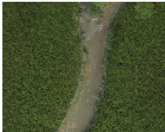
Abb. 12: True Orthophoto mit Artefakten im Gewässerbereich, die von geometrischen Restfehlern und radiometrischen Unterschieden benachbarter Bilder herrühren
