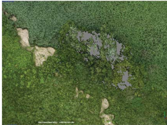
Abb. 9: Aus UAS-Befliegung abgeleitete 3D-Punktwolke für True Orthophoto
