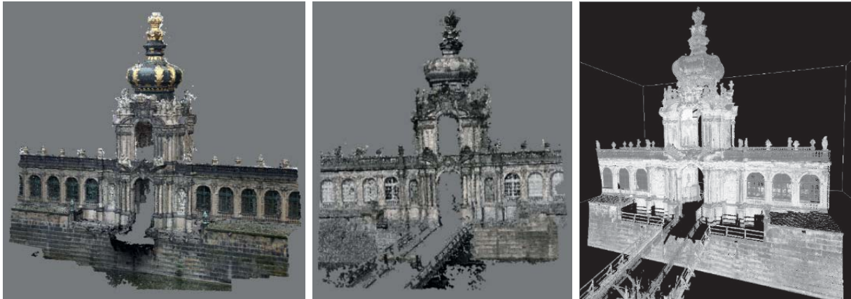
Abb. 9: Vergleich der Punktwolken basierend auf aktuellen (links) bzw. historischen Bildern (Mitte) sowie terrestrischen Laserscannerdaten (rechts)
