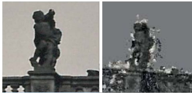
Abb. 4: Vergleich eines Ausschnitts aus historischer Aufnahme (links) und Punktwolke (rechts)
