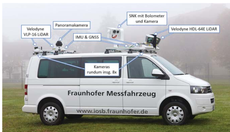
Abb. 4: Sensorfahrzeug „MODISSA“ von Fraunhofer IOSB. Dieses verfügt über verschiedene Sensoren, zu denen neben mehreren Kameras auch vier LiDAR-Sensoren gehören.
