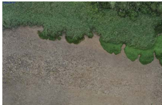
Abb. 3: 3D-Punktwolke mit fehlerhaften Bildzuordnungen im Watt
