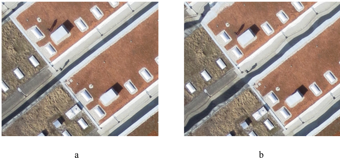
Fig. 10: Exemple d'orthophotos.(a) avec un modèle numérique cohérent. (b) avec un modèle numérique incohérent
