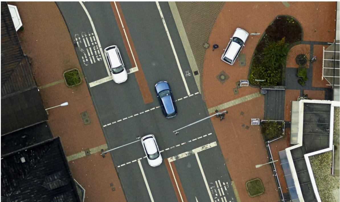
Abb. 4: Luftbild mit 2cm GSD, aufgenommen unter komplett geschlossener Wolkendecke am 22. Dezember 2015 in Kreuztal.
