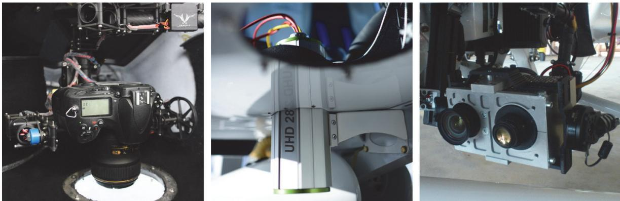
Abb. 2: Im Tragschrauber eingebaute Bildsensoren: Nikon D800e (links); Cubert UHD 285 Hyperspektralkamera (mittig); PANTIR Thermal Imager (rechts).
