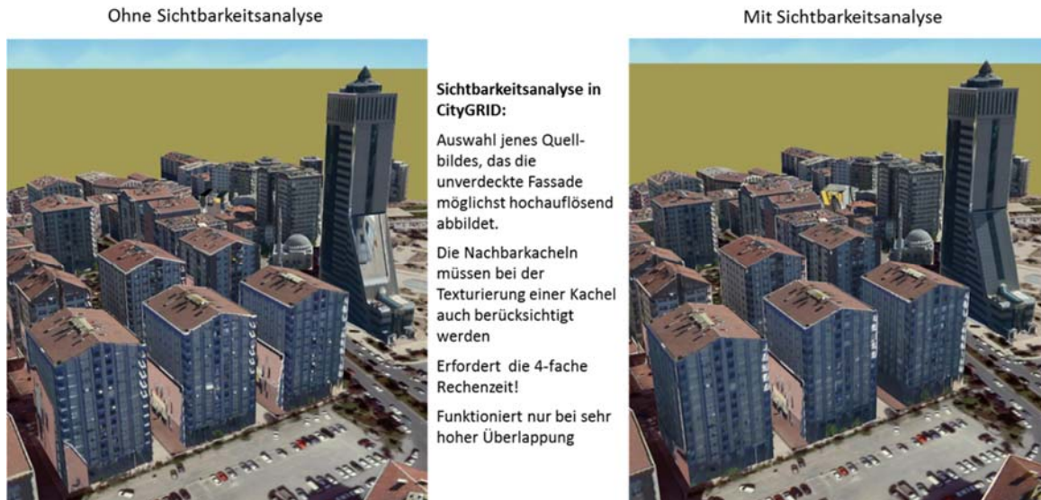
Abb. 7: Automatische Texturierung aus Schrägluftbildern, links ohne Sichtbarkeitsanalyse, rechts mit Sichtbarkeitsanalyse und Verdeckungsminimierung.
