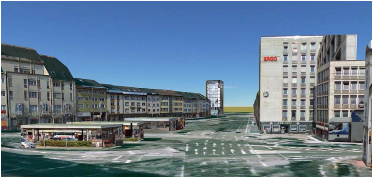
Abb. 11: Automatische Fassadentexturierung des Stadtmodells Freiburg aus CycloMedia Aufnahmen
