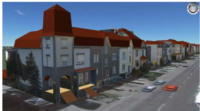
Abb. 12: Automatische Fassadentexturierung aus CycloMedia Aufnahmen mit anschließender interaktiver Modellierung von Arkaden, Stiegen, Erkern etc.
