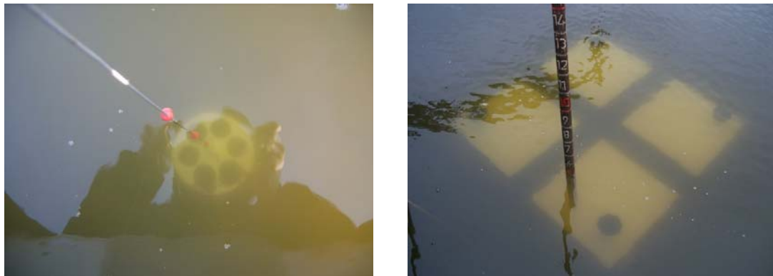
Abb. 2: Sichttiefenmessungen (links) und Referenzfläche unter Wasser (rechts)
