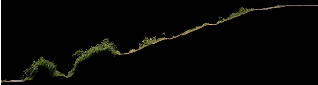
Abb. 3: Photogrammetrisch erzeugte 3D-Punktwolke beinhaltet Geländeoberfläche und Vegetationshülle
