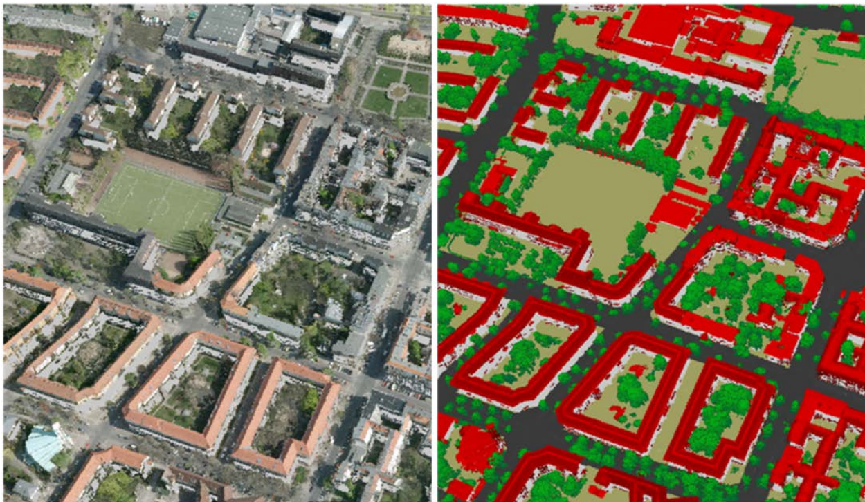
Abb. 3: 3D-Punktwolke einer Befliegung dargestellt mit Luftbildfarben (links) und auf Basis des Klassifizierungsergebnisses (rechts).
