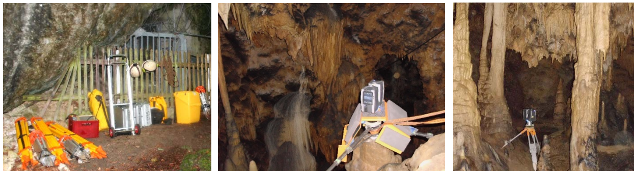
Abb. 4: Messausrüstung (links); Laserscanning über der Löwengrube (mittig) und in der Zaunikhalle (rechts).
