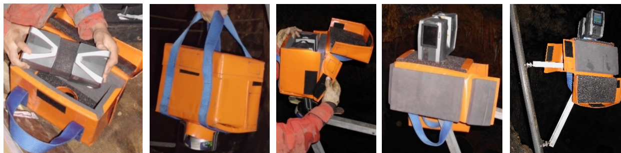
Abb. 2: Funktionsweise der Scannertasche und Aufbau auf dem Leiterarm.
