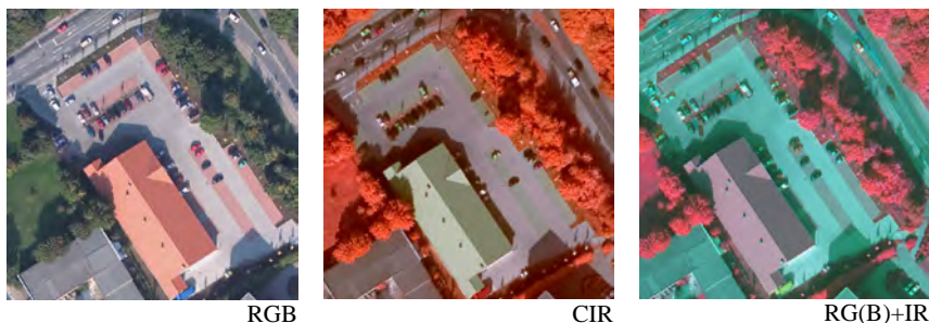
Abb. 1: Vergleich RGB, CIR und kombinierte Aufnahme aus Grün-, Rot und IR-Kanal, Datum 07.10.2005, GSD 15 cm
