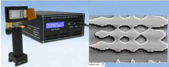
Abb. 1: Spatial Light Modulator mit Steuereinheit, beugende Substruktur nach BESSY-AZM. Daniel Schondelmaier
