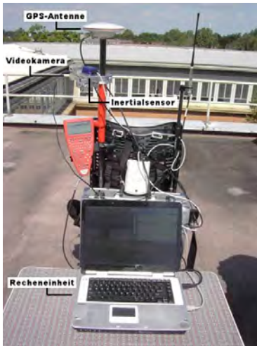
Abb. 1: Komponenten eines AR-Systems (STAUB, 2006)
