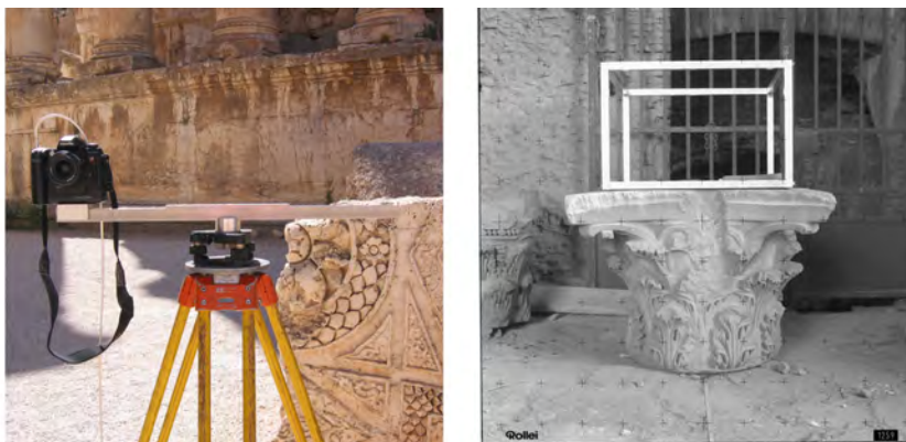
Abb. 1: Aufnahmeconfiguration vor Ort (links: Kameraschiene als Basis, rechts: Rahmen als 3D-Maßbezug)
