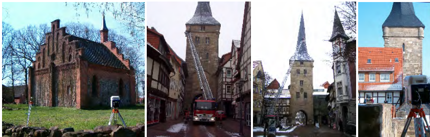
Abb. 2: Scanner und Kugel als Passpunkt vor der Kirche Raduhn (links), Drehleitereinsatz für Passpunktsignalisierung und photogrammetrische Aufnahme (Mitte), sowie Laserscannerstandpunkt beim Westerturm (rechts)
