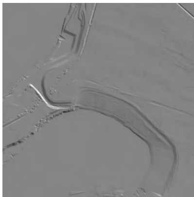
Abb. 8: Schummerdarstellung des digitalen Geländemodells (DGM) für den Partwitzer See, Brandenburg.
