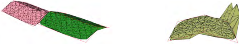
Abb. 7: Korrekt detektierte Gebäude (links) und ein mit Vegetation detektiertes Gebäude (rechts)
