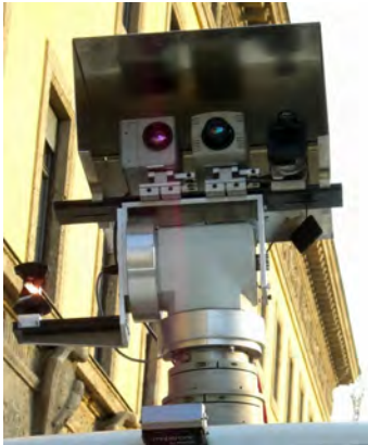
Abb. 3: Messaufbau: v.l.: Prisma, SC3000 Thermal IR Kamera, MerlinMID Mittel IR Kamera, Videokamera
