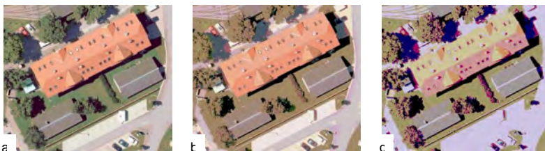
Abb. 3: Farb-Segmentierung des Bildes mit Multiple Thresholding
