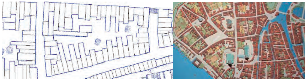
Abb. 4: Digitalisierte Grundrisse (schwarz) mit der überlagerten Punktwolke (blau) (links), Darstellung der dichten und komplexen Bebauung in der Nadiraufnahme eines Ausschnittes des Hamburger Holzmodells von 1644 mit signalisierten Punkten für die Verknüpfung der einzelnen Scans (rechts).
