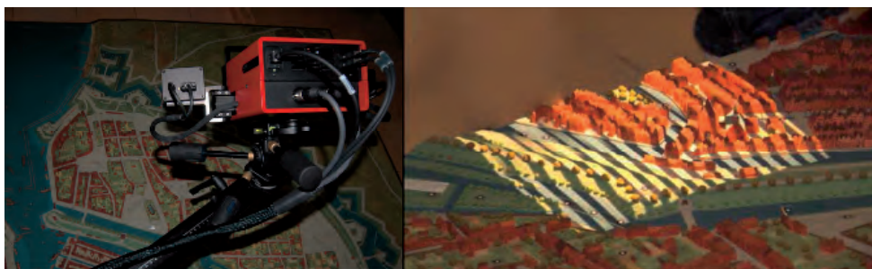
Abb. 2: Aufnahme des Holzmodells im Hamburgmuseum mit dem Streifenprojektionssystem ATOS I: Messsystem über dem Modell (links) und Aufnahmefenster mit Streifenmuster im Messbereich (rechts).
