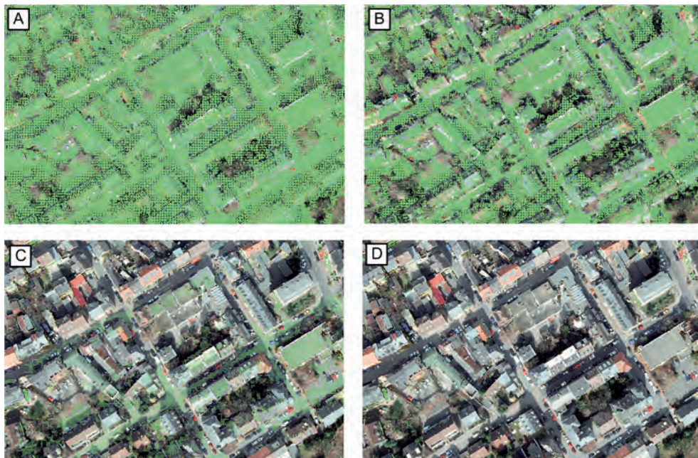
Abb. 4: Darstellung der 3D-Punktwolke mit unterschiedlichen LOD-Stufen in Abhängigkeit der projizierten Knotengröße für die Begrenzung des Tiefendurchlaufes (800 (A), 400 (B), 100 (C) und 1 Pixel (D)).
