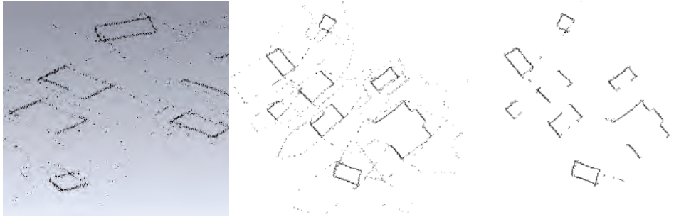
Abb. 3: Testdatensatz vom IMAGER 5006i: Punktwolke (links), Orthogonal-Projektion der Punktwolke als Bild (Mitte), Gebäudepunkte als Ergebnis der ersten Filterung (rechts).
