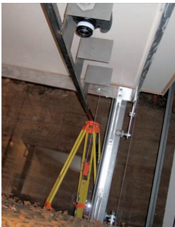
Abb. 4: Kameraaufhängung für die „Befliegung“ der Holzmodelle.
