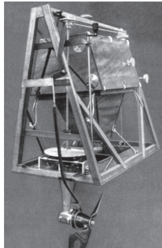
Abb. 24: Der erste »Reihenbildner« von OSKAR MESSTER im Jahre 1915. Der Luftschraubenantrieb lag unter dem Rumpf des Flugzeuges. Ein Reibradgetriebe erlaubte es, die Laufgeschwindigkeit stufenlos zu ändern.
