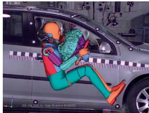
**Abb. 8:** Überlagerung von Simulationsdaten mit realen Bilddaten.
