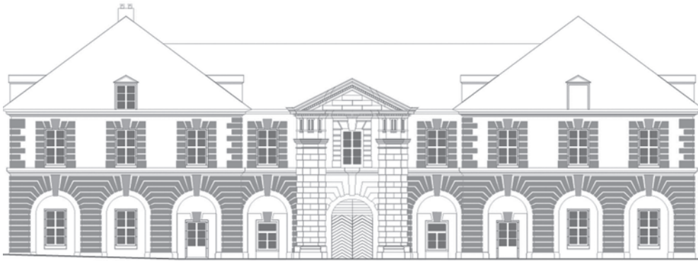
Abb. 7: Photogrammetrische Auswertung der hofseitigen Fassade im SVG-Format.
