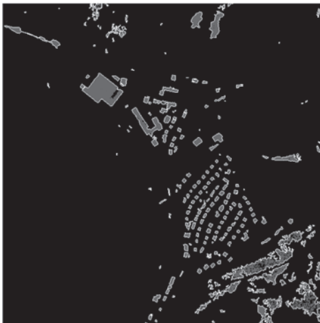
Abb. 6: Objektkonturen (helle Umrandungen) zur Formbestimmung.
