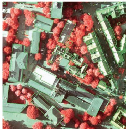
**Abb. 6:** CIR True-Ortho-Bild mit überlagerten Gebäudevektoren.
