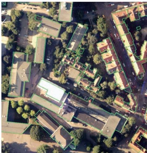
**Abb. 5:** RGB True-Ortho-Bild mit überlagerten Gebäudevektoren.
