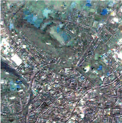
Abb. 13: Bildfusion durch Principal Component (PC): Kanäle 1, 2, 3 (Echtfarben Bild).
