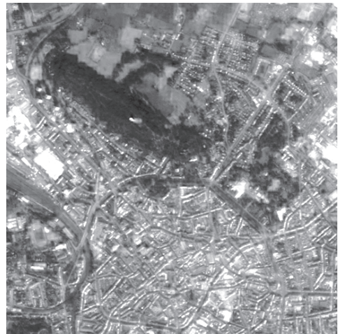
Abb. 10: Fusionierte SPOT/ETM Intensitätskomponente nach der Histogramm Anpassung.
