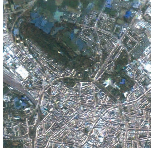
Abb. 15: Bildfusion durch Brovey Transformation: Kanäle 1, 2, 3 (Echtfarben Bild).
