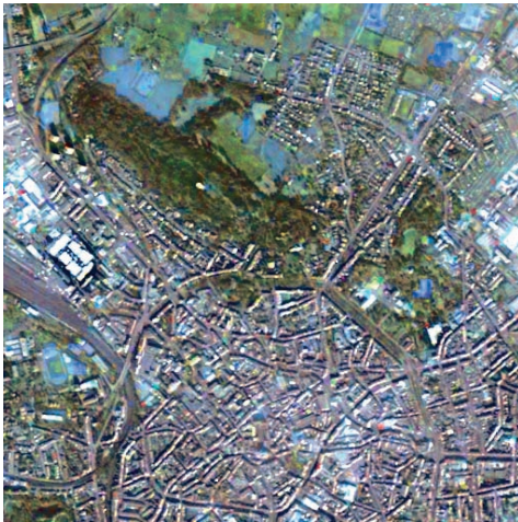
Abb. 11: SPOT/ETM IHS Bildfusion nach FFT basierter Filterung: Ergebnisse für die Kanäle 1, 2, 3 (Echtfarben Bild).
