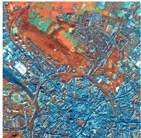
Abb. 16: Bildfusion durch Brovey Transformation: Kanäle 4, 5, 7 (Infrarot Bild).
