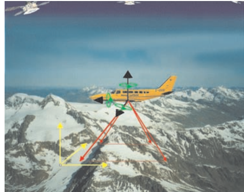
Abb. 5: Prinzip der direkten Geo-Referenzierung; Lage (X,Y,Z) und Orientierung ( \omega , \phi , \kappa ) werden im Flug mittels GPS/IMU erfasst.
