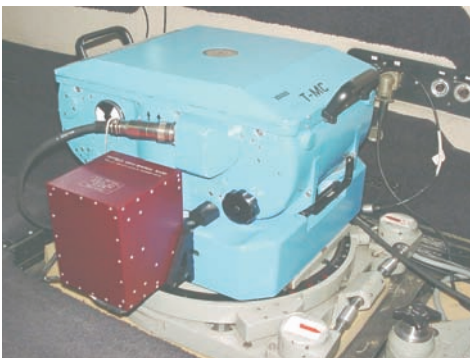
Abb. 1: Filmkamera RMK TOP (Z/I Imaging) mit inertialer Messeinheit AEROcontrol (IGI).
