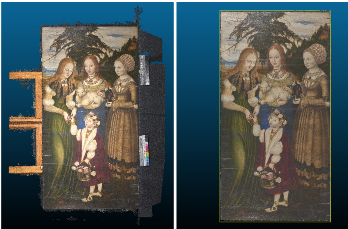
Abb. 2: Vergleich der unbearbeiteten Punktwolke aus Agisoft Photoscan (links) mit der bearbeiteten Punktwolke aus CloudCompare (rechts)
