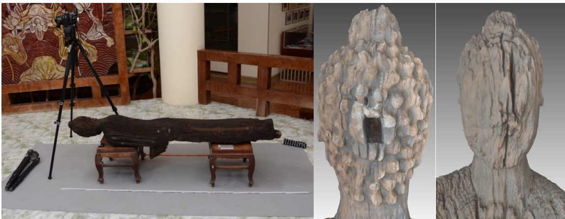
Abb. 2: Aufnahmeaufbau für den hölzernen Buddha (links) und 3D-Modell des Buddha-Kopfes (rechts)
