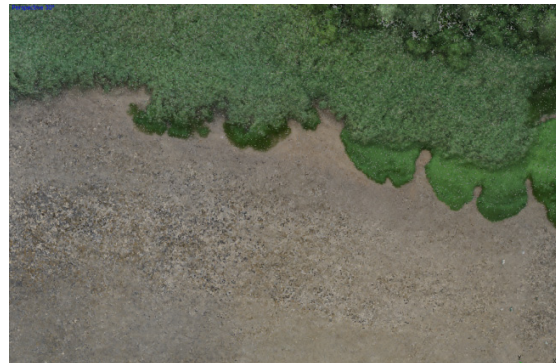
Abb. 3: 3D-Punktwolke mit fehlerhaften Bildzuordnungen im Watt
