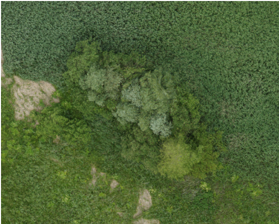
Abb. 7: True Orthophoto auf der Grundlage eines UAS-DOM mit nahezu lagerichtiger Darstellung der Bäume und Artefakten
