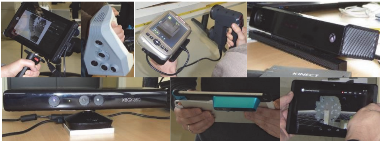
Abb. 2: Untersuchte handgeführte Scannersysteme (v.l.n.r.): DPI-7, Artec Spider, Mantis Vision F5, Kinect v2 (oben), Kinect v1, Structure Sensor und Google's Project Tango (unten).
