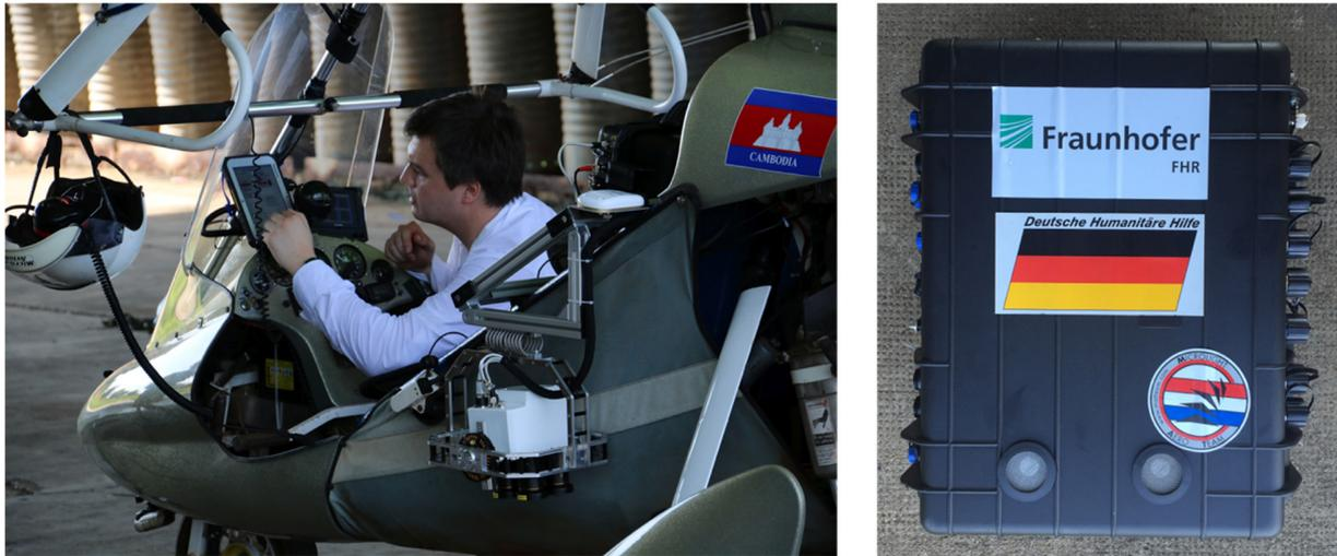
Abb. 4: *Links:* Ein Trike des Modells QuikR von P&M Aviation mit eingebautem FlugCase und Halterahmen für das Kamerasystem. Im Cockpit befindet sich das Navigationsdisplay. *Rechts:* Das FlugCase ist ein umgebauter robuster Kunststoff-Koffer. Seitlich sind die verschiedenen Systemanschlüsse zu erkennen.
