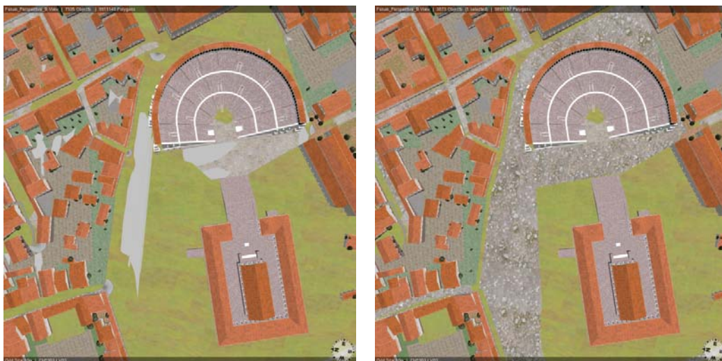
Abb. 3: Vergleich Strassennetzwerk mit grossem Platz als 2D-Geometrie (links) und als Objekte welche direkt in die Geländetextur gebrannt wurden (rechts).
