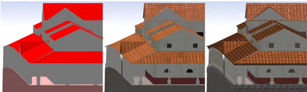
Abb. 4: Vergleich der drei Detaillierungsgrade LOD1 (links), LOD2 (Mitte), LOD3 (rechts) am Beispiel eines römischen Stadtquartiers.
