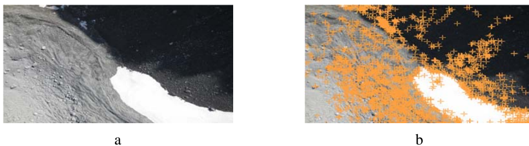
Fig. 5: Exemples de points homologues automatiques. (a) Image initiale et (b) points de liaison extraits
