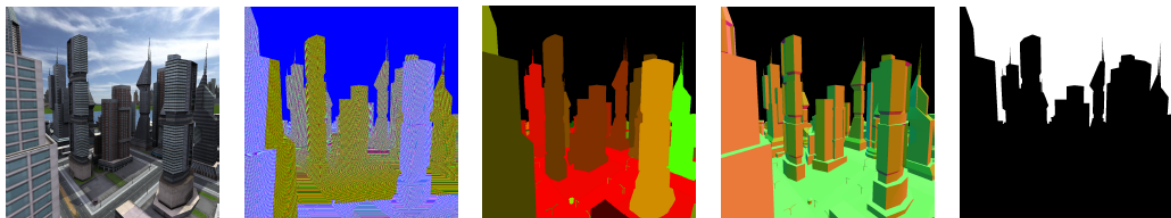
Abb. 1: Multi Layer Images: (v.l.n.r) RGB, Tiefenkarte, Objektidentifikation, Normalen, Maske (HAGEDORN 2009)
