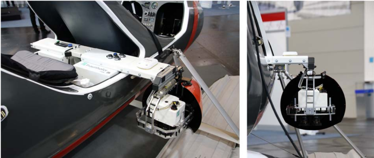
Abb. 3: FlugKit für AutoGyro MTOsport. Zu sehen ist auf dem linken Bild das eingebaute Trägersystem mit seinen zwei Containern für die Energieversorgung (links) und die Computersteuerung sowie GPS (rechts). Das rechte Bild zeigt eine Detailaufnahme der Außenlasthalterung für die Sensoren mit elektromechanischer Lageregelung.
