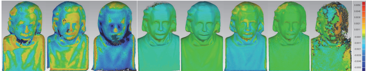
Abb. 7: Abweichungen [m] an der Einstein-Büste nach 3D-Vergleich (Testdaten vs. Referenzdaten) (v.l.n.r) - DPI-7 dhp:i, DPI-7 LKA, DPI-7 HSBO, Artec Spider, Mantis F5, Structure Sensor, Nikon D800, Galaxy Note 1. Farbskala: Grün < 0,0001 m, rot < 0,005 m und blau > -0,005 m.
