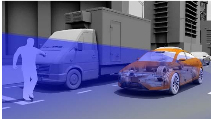
Abb. 1: Unfallvermeidung durch Detektion eines Fußgängers im Fahrweg des Autos mit Hilfe eines Stereokamerasystems am Innenspiegel [CONTINENTAL, 2011]
