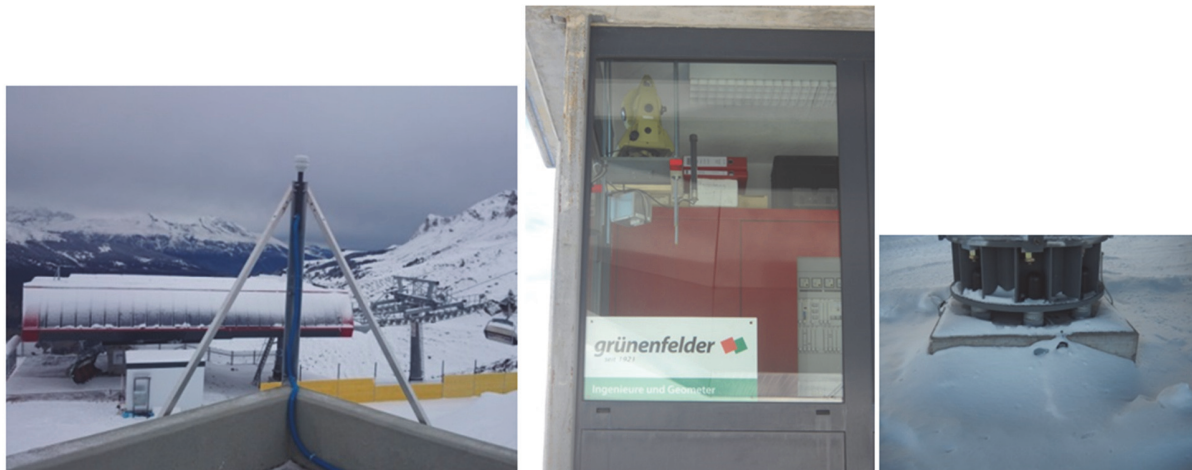
Abb. 5: Von links: GNSS-Antenne (Vordergrund) und Seilbahnstation Heimberg (Hintergrund); Tachymeter-Station im Betriebsraum; Neigungssensoren-Box im Schnee (© Grünenfelder und Partner)
