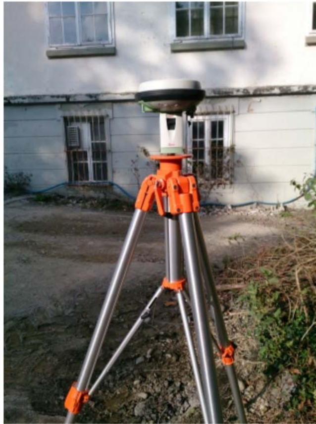
Fig. 6 : Antenne GNSS substituée à la tête panoramique
