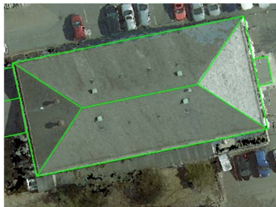
Abb. 4: Überlagerung der Punktwolke und der LoD2-Daten (grün)
