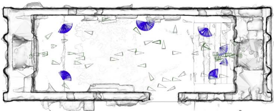
Abb. 3: Standorte und Blickrichtungen der Innenaufnahmen im Grundriss des erzeugten 3D-Modells (touristische Fotos: grün; Panoramas: blau)
