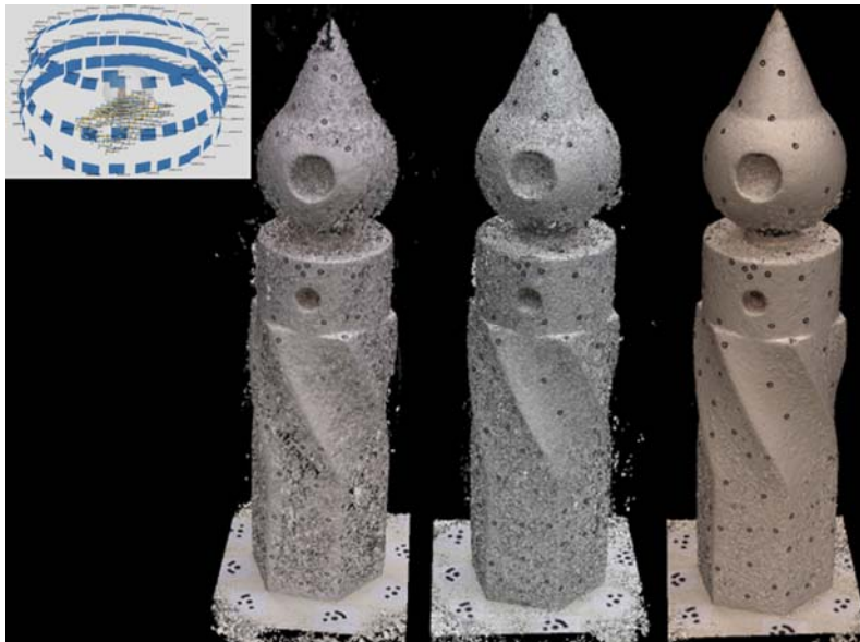
Abb. 7: 3D-Punktwolke eines Testkörpers: Sensoren mit Bayer-Pattern (links und Mitte). Rechts das Ergebnis aus Bilddaten eines Foveon-Chips.
