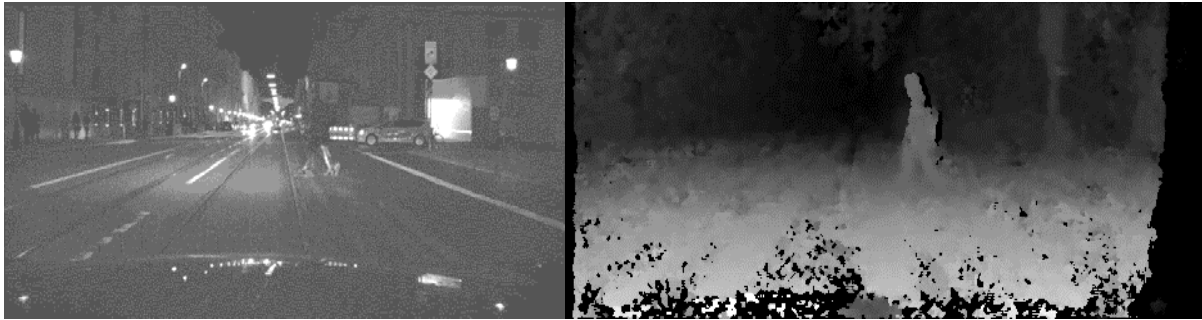
Abb. 3: Beispielaufnahme (aufgehellt) eines Fahrzeug-Stereokamerasystems in der Nacht. Links: Rektifiziertes Grauwertbild, rechts: Disparitätsbild.
