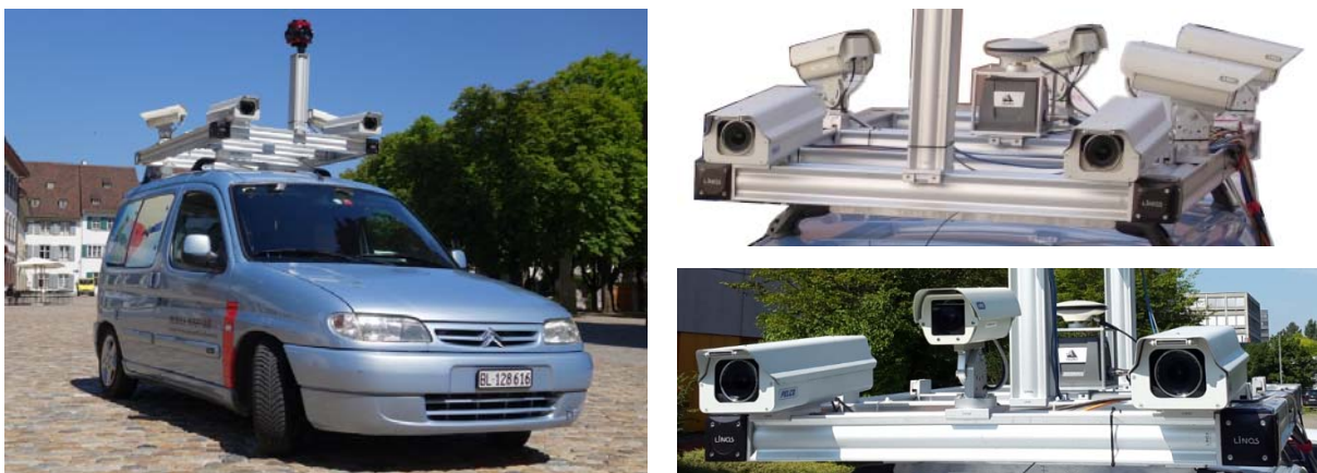
Abb. 1: Mobile Mapping System des IVGI (links), Sensor-Konfiguration für die Messfahrt Juli 2014 (rechts oben) und für die Messfahrt August 2015 (rechts unten)
