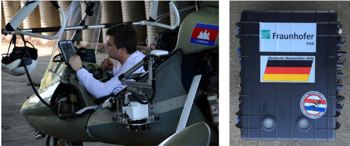
Abb. 4: Links: Ein Trike des Modells QuikR von P&M Aviation mit eingebautem FlugCase und Halterahmen für das Kamerasystem. Im Cockpit befindet sich das Navigationsdisplay. Rechts: Das FlugCase ist ein umgebauter robuster Kunststoff-Koffer. Seitlich sind die verschiedenen Systemanschlüsse zu erkennen.
