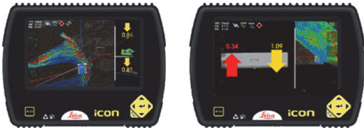
Abb. 3: Ansichts-Modi des Fahrer-Displays mit Schneehöhen
