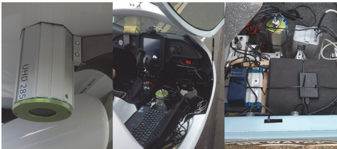
Abb. 1: Links und Mitte: Cubert UHD 285 im Tragschrauber Cloud Dancer 2 des AMLS; rechts: selbe Kamera im Tragschrauber Trojan der Firma GyroLAG in Südafrika.
